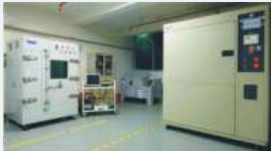
Камера испытаний на естественную конвекцию (слева) Камера испытаний на стойкость к тепловому удару (справа)
